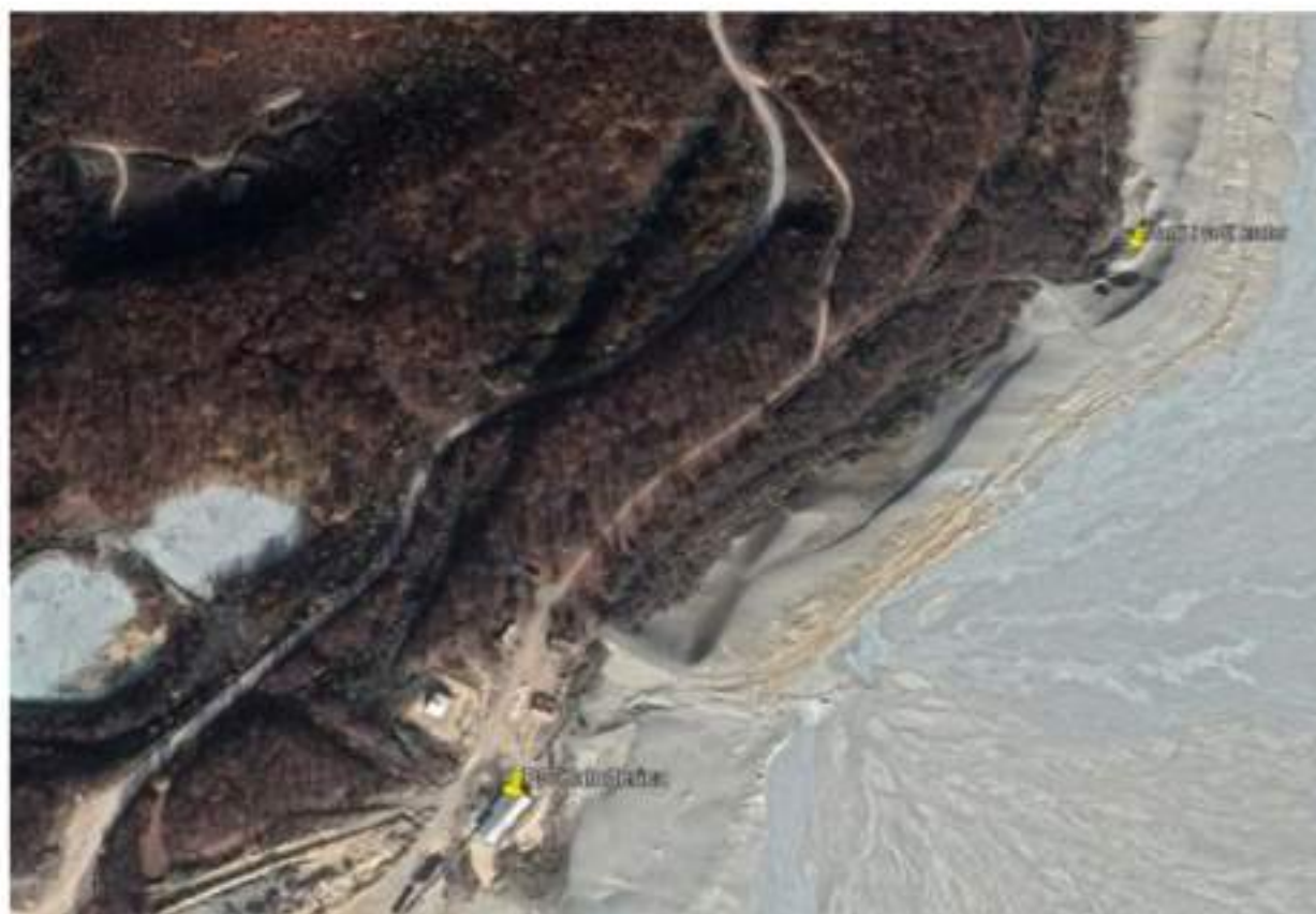
Slika 10.7 - Manji i veći krater oko 380 m uzvodno od PS "KaludERICA". Manji krater prečnika oko 8 m i veći prečnika oko 17 m, Google Earth, snimak od avgusta 2020. godine
