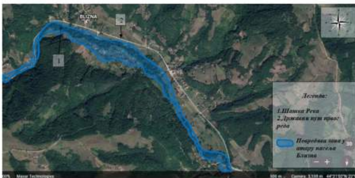
Слика 9.55.- Графички приказ симулације поплавног таласа сценарија у атару насеља Близна
