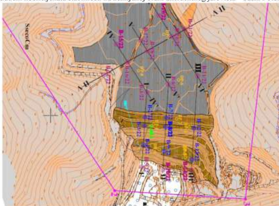
Slika 9.43. – Prikaz lokacija svih dodatnih geotehničkih istražnih bušotina iz Projekta
